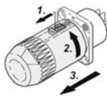
拆卸电源线
