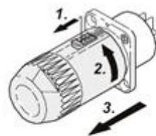
拆卸电源线
